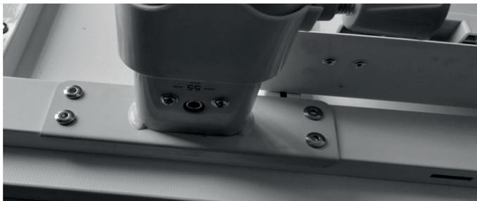
1. Совместите ножки со стойками стальной рамы и прикрутите стол. Не затягивайте винты. 2. Перед установкой ножки стола убедитесь, что размер шкалы одинаков. 3. Сначала закрепите винт опоры стола.
