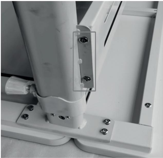
Установите пластину, предварительно не затягивая её. После этого прикрутите и затяните все винты, относящиеся к пластине.
