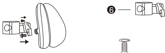
Оденьте спинку кресла сверху на каркас. Сначала снимите ручку, чтобы пружинный штифт не заблокировался, и затяните ее до положения отверстия, как показано на рисунке.
