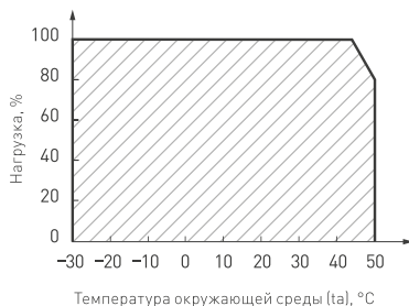
Рис. 2. Максимальная допустимая нагрузка, % от мощности источника
