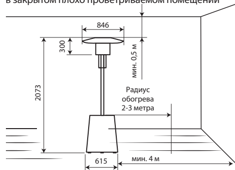
Рис. 1в – Размеры прибора и допуски (0,5 min)
