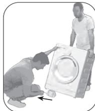
Чтобы удалить элементы жесткости, наклоните машину назад и потяните за ленту. Не совершайте это действие самостоятельно.
