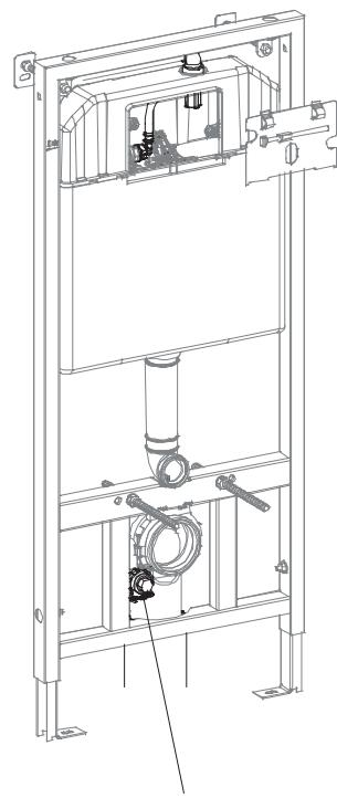
5. Аккуратно удалите крышку кнопочного узла. Соедините гибкую подводку воды с угловым клапаном, надежно соедините узел. Проверьте все соединения углового клапана, чтобы предотвратить утечку и верните крышку кнопочного узла на место.
