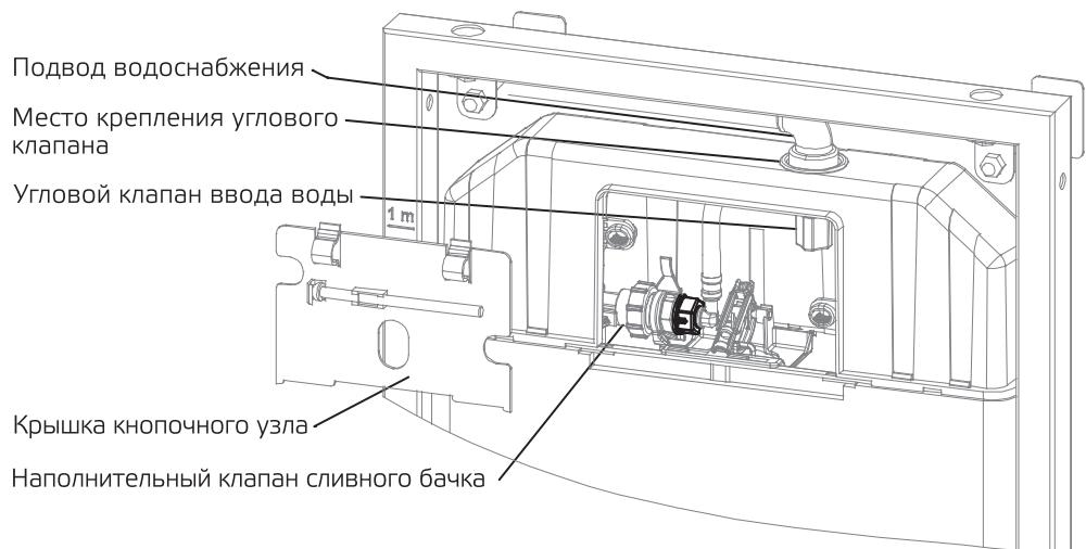
6. После выполнения всех этапов установки инсталляция теперь закреплена к стене и соединена с основной системой водоснабжения и канализации. Чтобы предотвратить проблемы загрязнения во время процесса цементирования или укладки плитки установите на время монтажа: заглушку впускной трубы, заглушку смыывной трубы, защиту шпилек и защитный кожух кнопочного узла.
