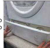
2. Поверните два фиксирующих рычага против часовой стрелки и потяните за конденсатор
