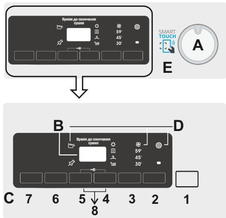
**A – Переключатель выбора программы:** Чтобы выбрать программу, вращайте переключатель в обоих направлениях. Отменить выбранную программу или выключить машину, вращайте ручку до положения OFF.
