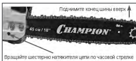
Рис. 5 Регулировка натяжения цепи
