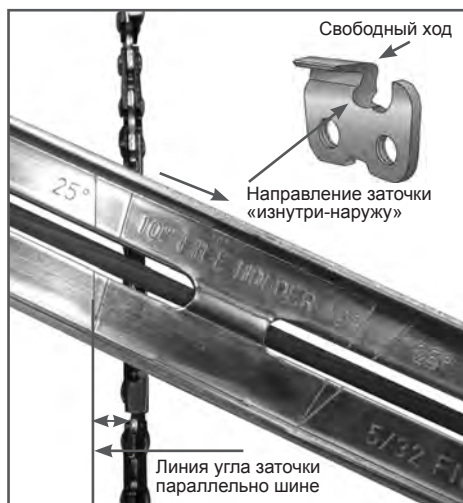
Рис. 22 Расположение линии угла заточки
