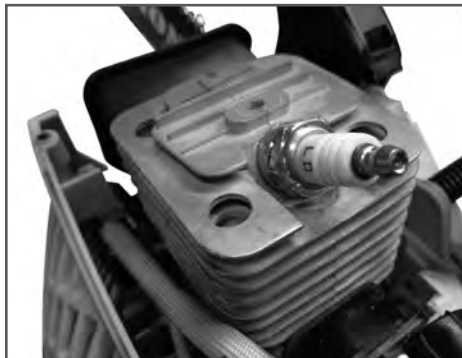
Рис. 28 Охлаждающие ребра цилиндра
