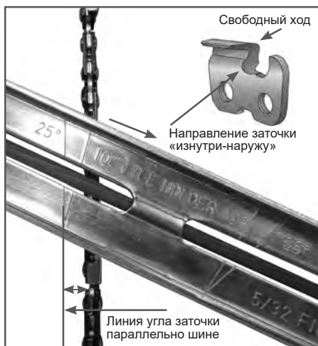
Рис. 22 Расположение линии угла заточки
