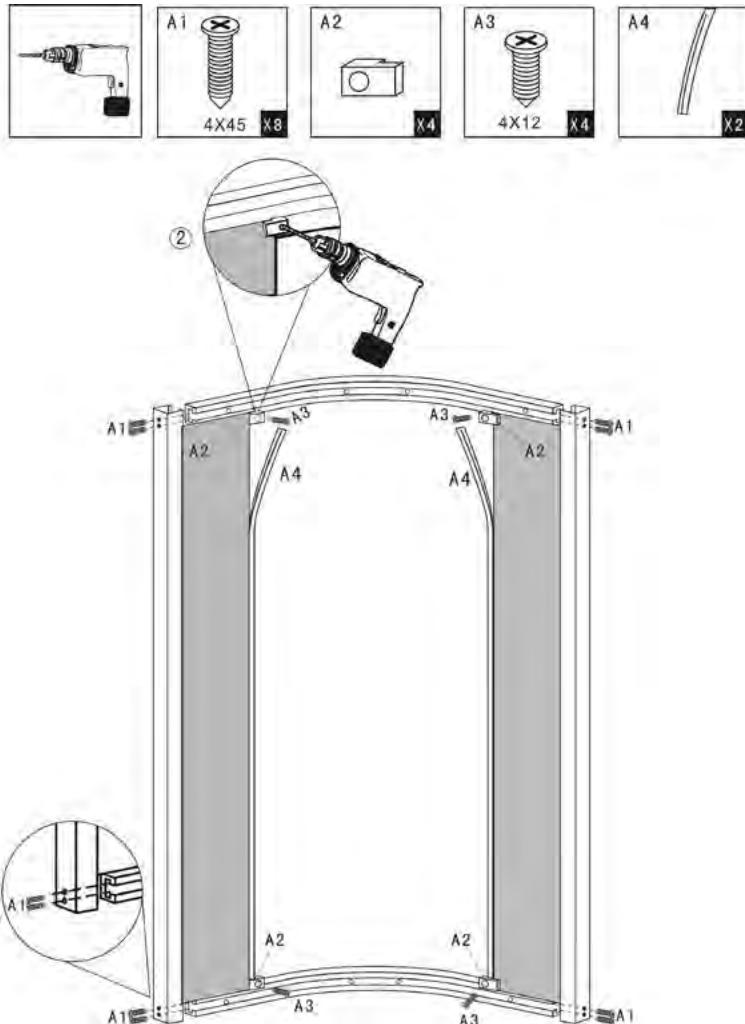
Когда рама собрана и Вы убедились, что неподвижные стекла становятся в раму, прикрепите раму к стене. Оденьте уплотнитель на ту сторону неподвижного стекла, которое вставляется в металлическую раму. Вставьте стекло в раму. Закрепите его при помощи уголков А2. Сделайте тоже самое со вторым стеклом.
