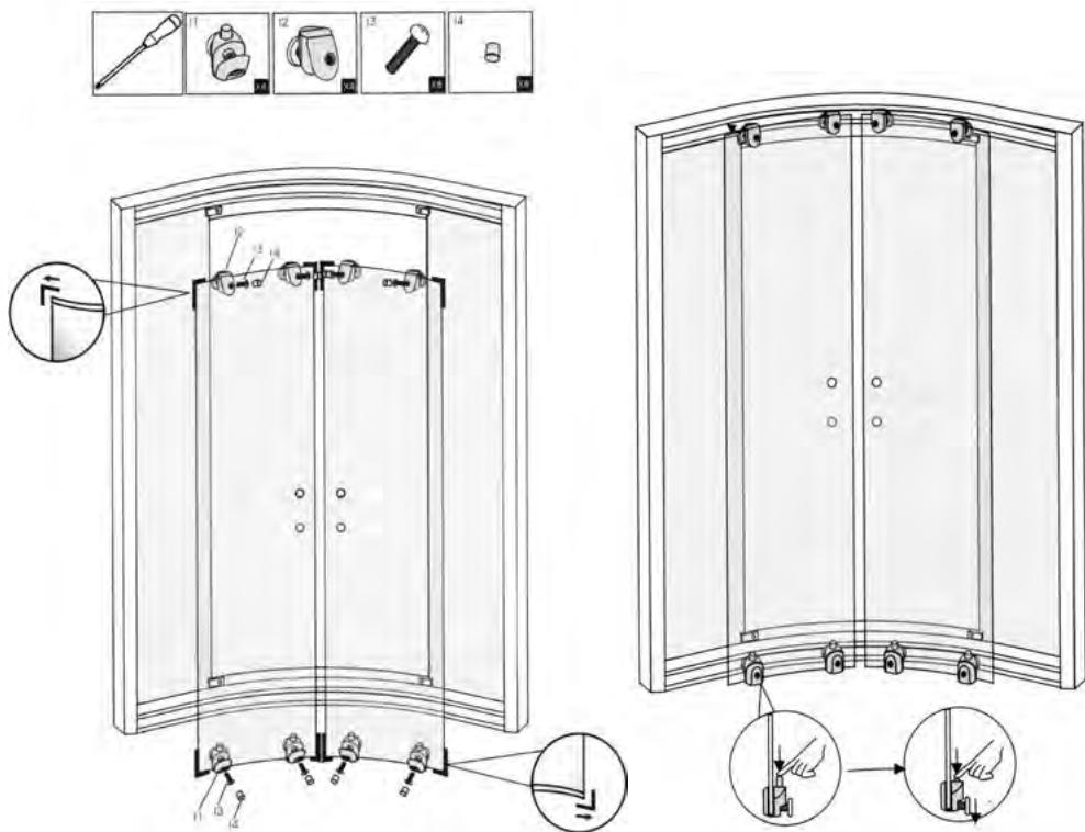
Поставьте Г-образные отсекатели на заднюю часть дверей и неподвижное стекло, чтобы вода не вытекала из изделия во время приема душа. Если у вас в комплекте идет 2 отсекателя, тогда они устанавливаются на неподвижное стекло.
