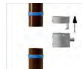
2. Отсоедините крышку водосборника
