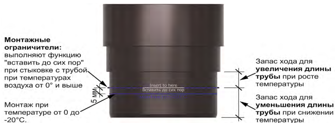
Рис. 32 Предохранительная система водоотведения на фитингах BC PREMIUM и STANDARD
