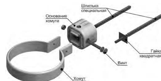
Рис. 34 Хомут LUX универсальный и шпилька с гайкой
