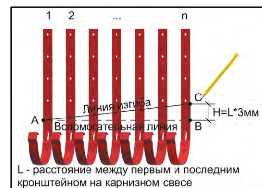
Рис. 13 Разметка кронштейнов для последующего изгиба
