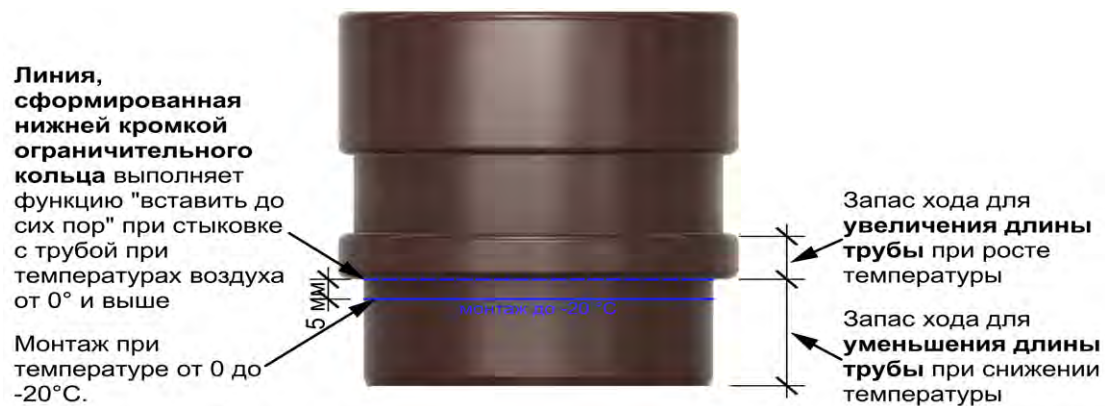
Рис. 33 Предохранительная система водоотведения на фитингах BC LUX
