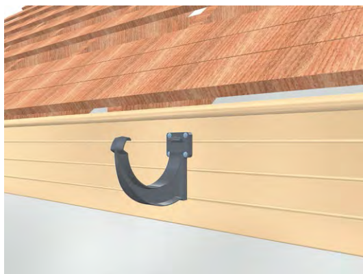
Рис. 11 Особенности монтажа кронштейнов на полимерный материал
