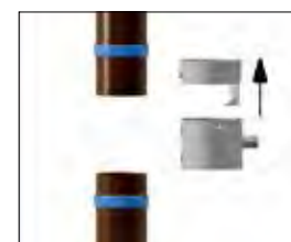
2. Отсоедините крышку водосборника
