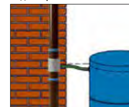
8. Соедините водосборник с ёмкостью
