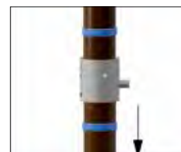
1. Опустите нижнюю водосточную трубу таким образом, чтобы демонтировать водосборник
