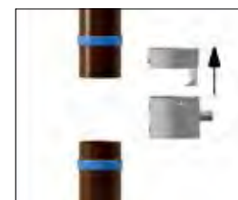
2. Отсоедините крышку водосборника
