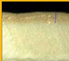
Сайдинг Döcke под микроскопом 200x
