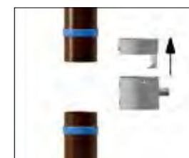
2. Отсоедините крышку водосборника
