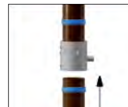
6. Установите водосборник и поднимите до упора нижнюю водосточную трубу
