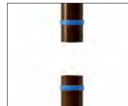
5. Установите дополнительные водосточные хомуты (не входят в комплектацию) для надёжной фиксации трубы к фасаду здания
