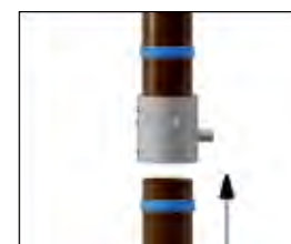
6. Установите водосборник и поднимите до упора нижнюю водосточную трубу
