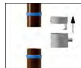
2. Отсоедините крышку водосборника
