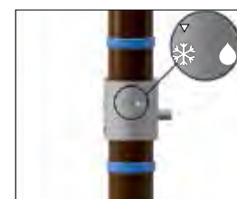
2. Переведите водосборник в зимний режим путём проворачивания стакана для сбора воды в положение «снежинка»
