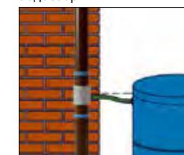
8. Соедините водосборник с ёмкостью
