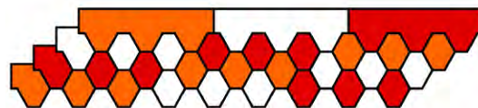
Рис. 19. Схема чередования гонтов битумной черепицы Döcke PIE на примере гексагональной формы гонта.
