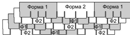
Рис. 20. Схема чередования гонтов гибкой черепицы Döcke PIE PREMIUM коллекции «Саппоро».
