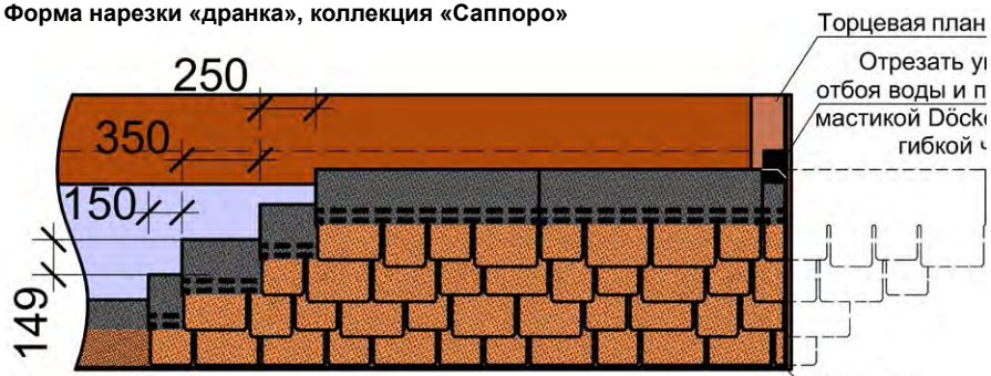
Рис. 24. Схема смещения гонтов по горизонтали и вертикали.
