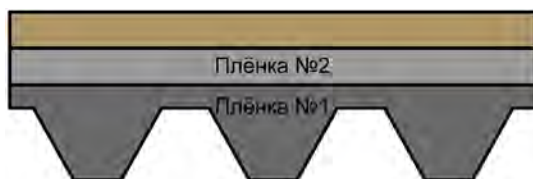
Рис. 13 Тыльная сторона гонта гибкой черепицы Döcke PIE.
