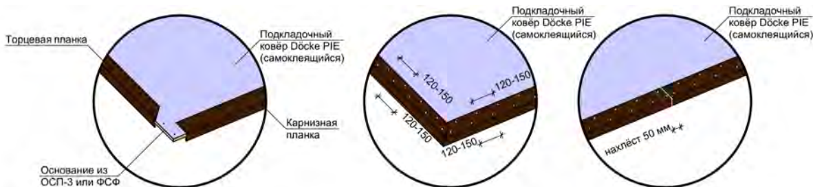
Рис. 8 Крепление металлических карнизных и торцевых планок.
