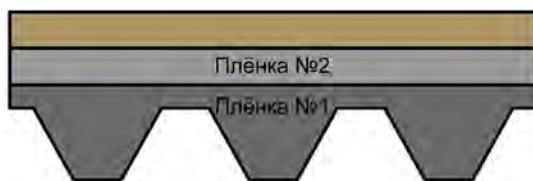
Рис. 13 Тыльная сторона гонта гибкой черепицы Döcke PIE.
