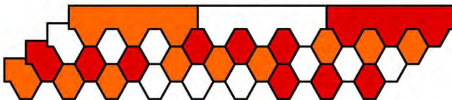
Рис. 14 Схема чередования гонтов битумной черепицы Döcke PIE на примере коллекции «Сота». Каждый цвет соответствует отдельной упаковке битумной черепицы. Схема актуальна для всех коллекций битумной черепицы, кроме коллекции «Саппоро».
