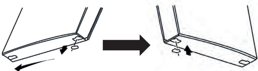
5 Переверните верхнюю петлю на 180° (так, чтобы штифт был направлен вверх) и закрепите ее на противоположной стороне в нижней части прибора. Установите дверцу морозильной камеры обратно на нижнюю петлю.
