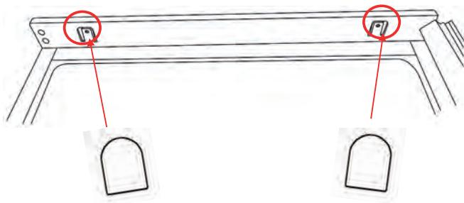
Наденьте заглушки для ножек, защелкнув их на ножках в нижней части прибора. Пластиковые стержни указывают, какое должно быть расстояние между продуктом и краем шкафа (примерно 42 мм). После установки заглушек отломите пластиковые стержни.
