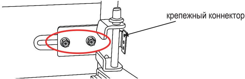
Слот на крышке петли, 2 зажима на задней стороне должны быть установлены в кронштейн средней петли.
