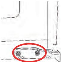
4 Снимите все заглушки с резьбовых крышек на противоположной стороне прибора от того места, где только что были сняты петли. Снимите заглушки с петель в верхней части дверцы морозильной камеры, а также в верхней и нижней частях дверцы холодильника и закрепите их на противоположной стороне. Закрепите снятые резьбовые крышки на противоположной стороне ( дополнительно, в комплекте поставляются запасные ).
