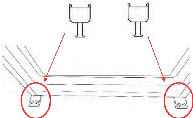
Откройте дверцу шкафа и дверцу холодильника, отметьте на задней части дверцы шкафа место, где заканчивается верхняя часть дверцы холодильника. Поместите дверную направляющую А на заднюю часть дверцы шкафа в месте, показанном ниже, и отметьте положение первого и последнего отверстий на дверной направляющей. Закрепите дверную направляющую с помощью 2 винтов Торх.
