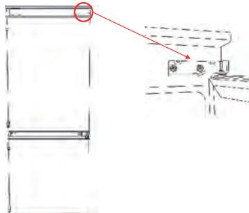
2. Снимите штифт петли и открутите 2 винта со средней петли. Снимите петлю и дверцу морозильной камеры, осторожно подняв ее вверх и в сторону от прибора. Не закрепляйте петлю на противоположной стороне на этом этапе, см. следующий шаг.
