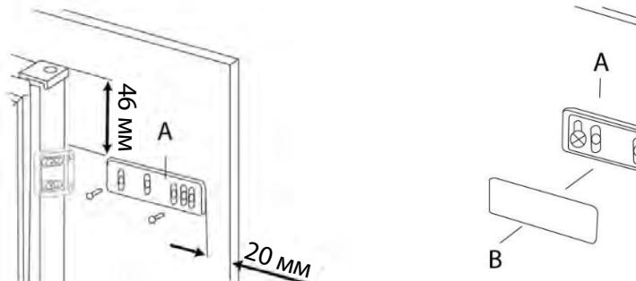
Откройте дверцу прибора и дверцу шкафа на 90°, выкрутите 2 винта из держателя направляющей дверцы, который уже прикреплен к дверце, и поместите его на направляющую дверцы А. Сдвиньте дверцу прибора и дверцу шкафа вместе, совместите отверстия в держателе направляющей дверцы с отверстиями на краю дверцы и закрепите на месте с помощью 2 снятых ранее винтов.
