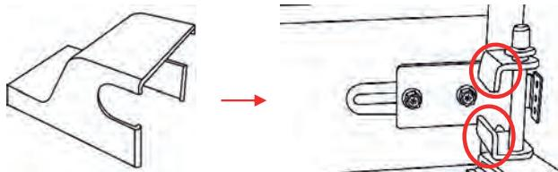
В комплект поставки входят еще 2 крышки петель, предназначенные для нижней и верхней петель. При необходимости их можно закрепить.
