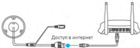
Рисунок 5-3 Подключение к роутеру
