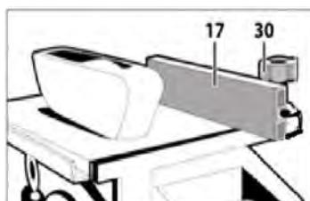
Установка необходимой ширины пиления: отпустите винт(ы) (30), по шкале подъемного стола (18) установите необходимую ширину пиления и затяните винт(ы).
