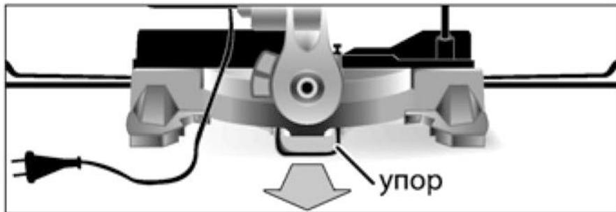
Установите изделие на ровной горизонтальной поверхности и, при необходимости, закрепите его через отверстия в основании.
