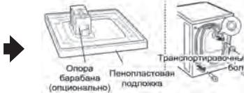
Снимите транспортировочные болты и опоры.
