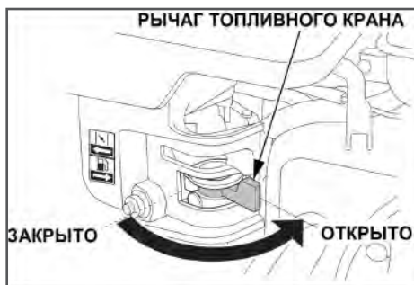
Рис. 13 Рычаг топливного крана
