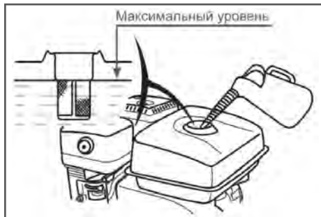
Рис. 10 Максимальный уровень топлива в топливном баке
