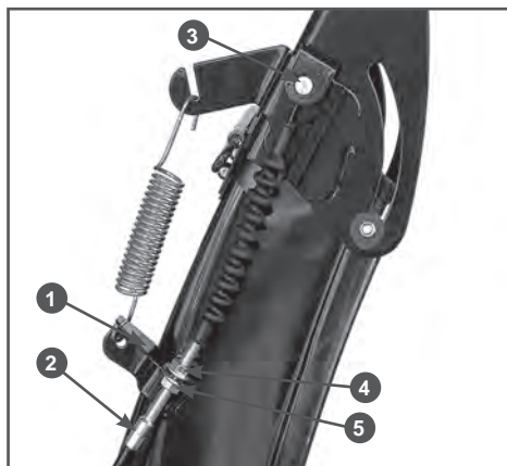
Рис. 6 Установка троса управления дефлектора желоба
