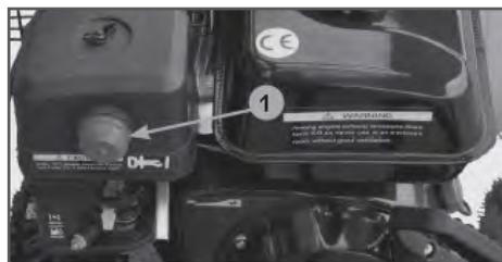
Рис. 16 Расположение ручного топливного насоса
