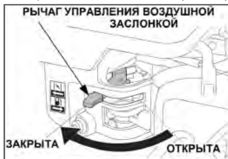
Рис. 12 Рычаг управления воздушной заслонкой
