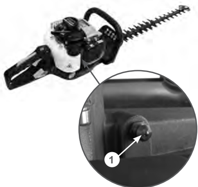
Рис. 16 Расположение пресс-маслёнки 1. Пресс-маслёнка
