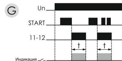
Г. Отсчет времени начинается после отключения сигнала START. Во время отсчета времени реле не реагирует на сигнал START.
