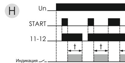
Н. Подача напряжения на вход START вызывает включение исполнительного реле, а сброс его начало отсчета времени  $t$ . Подача последующих импульсов START и сброс его вызывает продолжение цикла работы на время  $t$ .
