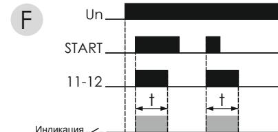
Ф. Контакты исполнительного реле замыкаются на установленное время  $t$  при подаче напряжения на вход START. В этот период времени устройство не реагирует на импульсы START.
