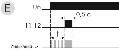
Е. Замыкание контактов исполнительного реле на время 0,5 секунды. По истечении заданного времени  $t$ .
