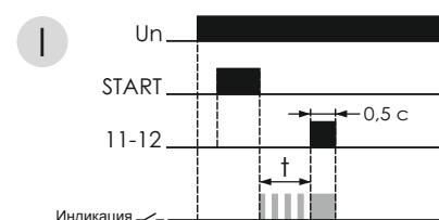
И. По окончании подачи напряжения на вход START начинается отсчет заданного времени  $t$ , по истечении которого, контакты исполнительного реле замыкаются на время 0,5 секунды. Во время отсчета времени реле не реагирует на сигнал START.
