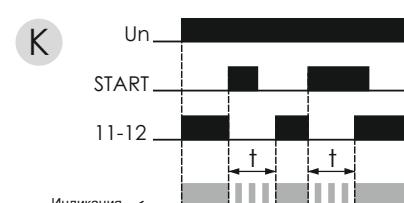
К. Выключение реле на определенное время  $t$ . При подаче напряжения на вход START начинается отсчет времени. В ходе отсчета устройство не реагирует на сигнал START.
