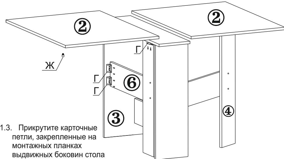
1.3. Прикрутите карточные петли, закрепленные на монтажных планках выдвижных боковин стола к боковинам стола.
