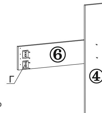
1.2. Прикрепите шурупами 3,5x16 карточные петли (поз.Г) к монтажным планкам выдвижных опор (дет.№№6).
