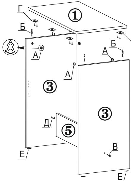
1.1. В отверстия на столешнице (дет.№1) закрутите штоки эксцентриков (поз.Б), шурупами 3,5x16 закрепите карточные петли (поз.Г), вставьте полкодержатели.
