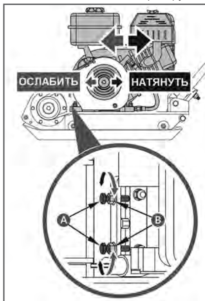
Рис. 31 Регулировка натяжения ремней РС6337F
