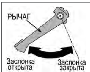
Рис. 14 Рычаг управления воздушной заслонкой PC5332F (вид сверху)
