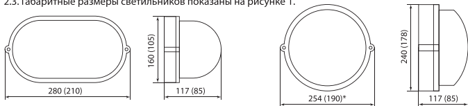
Рисунок 1. Габаритные размеры, мм
