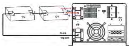
Схема подключения аккумуляторных батарей U=24В. Модель PSW-HW 2500–3500 Вт EKF PROxima
