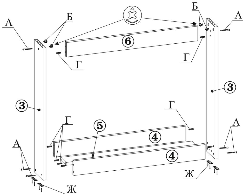
3.1. На нижних торцах боковин стола (дет.№№3), с помощью гвоздей закрепите наконечники (поз.Ж). Установите в соответствующие отверстия боковин шканты (поз.Г) и эксцентрики (поз.Б), так чтобы стрелка на них была направлена в сторону торцевых отверстий.
