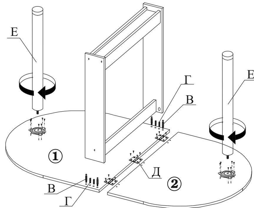
3.3. На нижней стороне столешниц (дет.№№1и2), шурупами 3,5x16 закрепите площадки опор (поз.Е) и вкрутите в них опоры. В основную столешницу (дет.№1) вкрутите штоки эксцентриков (поз.В), и установите шканты (поз.Г).
