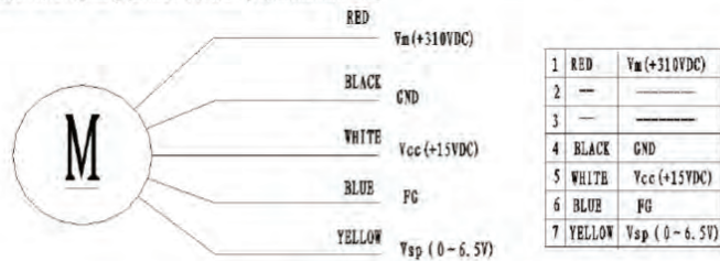
Вентилятор внутреннего блока (постоянный ток)
