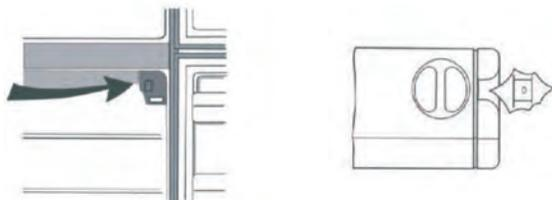
Температура в холодильнике уменьшается с увеличением значения позиции термостата от 1 до 7 по часовой стрелке. Для срочного замораживания пищи или быстрого приготовления льда, установите ручку термостата в положение 7. Рекомендуется устанавливать ручку в положение 5 при обычном использовании.
