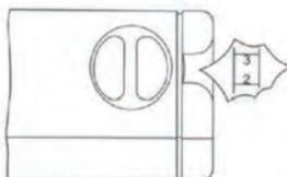
Когда температура окружающей среды слишком низкая (ниже 10 °С), компрессор может остановиться на длительный период, а температура в морозильной камере станет слишком высокой. В этом случае необходимо нажать на соответствующую кнопку сезона, установленную под термостатом.
