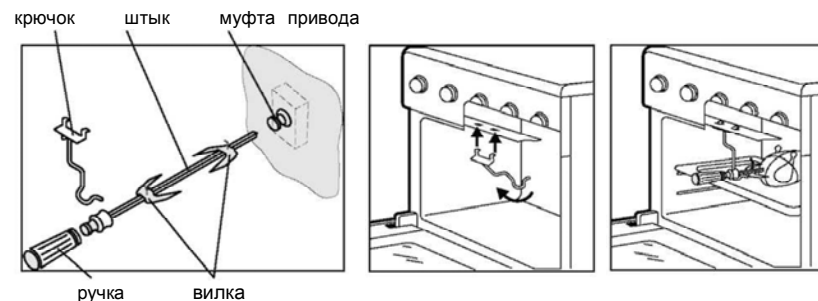
Рисунок 11 – Схема установки вертела
