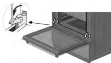
Рисунок 14 – Схема демонтажа дверцы духовки
