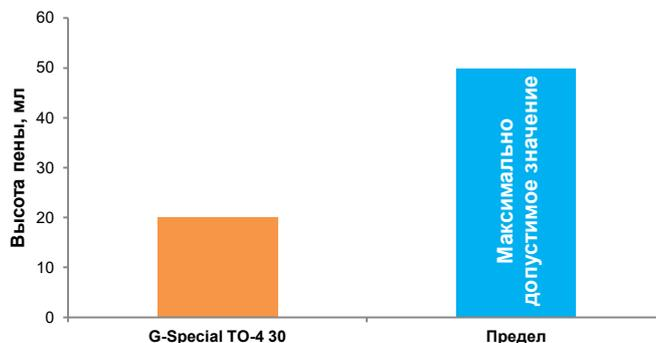
Низкая склонность к пенообразованию G-Special TO-4 30 позволяет увеличивать производительность гидравлической системы.
