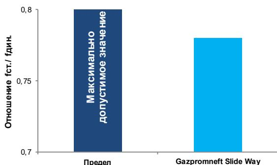
Масла серии Gazpromneft Slide Way предотвращают прерывистое скольжение направляющих и кареток, обеспечивая высокую точность обработки.
