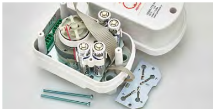
Фото 17. Контактная площадка снята, батарейки могут быть заменены
