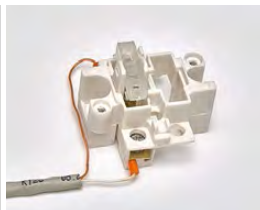
Фото 22. Подключение проводного выключателя
