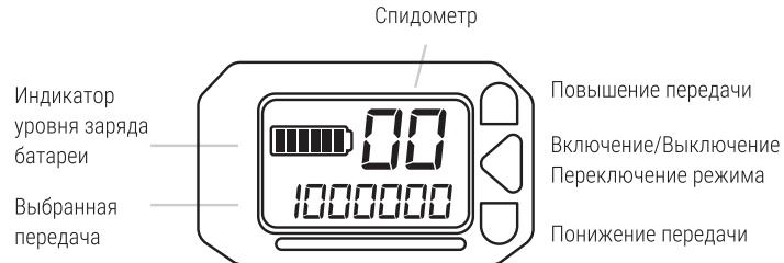
Режимы работы: пробег в течение последнего сеанса использования, Одометр, Время в пути, Напряжение на АКБ
