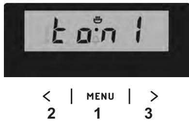
Mit dem Sensor **2** wählen Sie den entsprechenden Ton im Bereich von 1 bis 3 aus.
