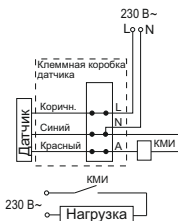
Рисунок 21 – Схема подключения датчика с контактором КМИ
