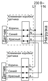
Рисунок 19 – Схема параллельного подключения датчиков
