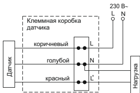
Рисунок 22 – Схема подключения датчиков типов: ДД 013, ДД 015, ДД 016
