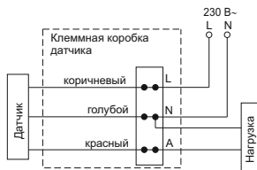
Рисунок 23 – Схема подключения датчиков типов: ДД 022, ДД 023
